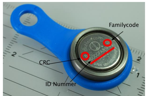
Abbildung 4: Bedeutung der aufgelaserten Beschriftung des Schlüssels
